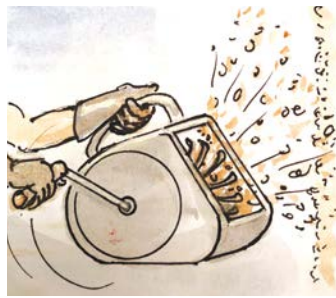
Projection à la main et projection mécanique à la « tyrolienne ».
